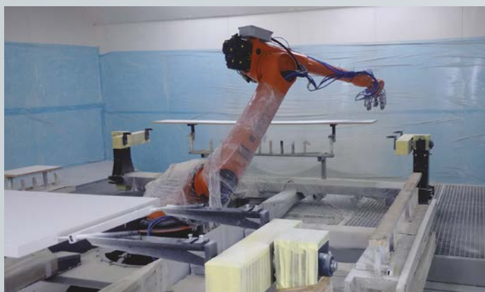
LeBot IA6 poate vopsi panouri din lemn sau uși cu ajutorul unității speciale rotative și a unității de scanare Lesta.
