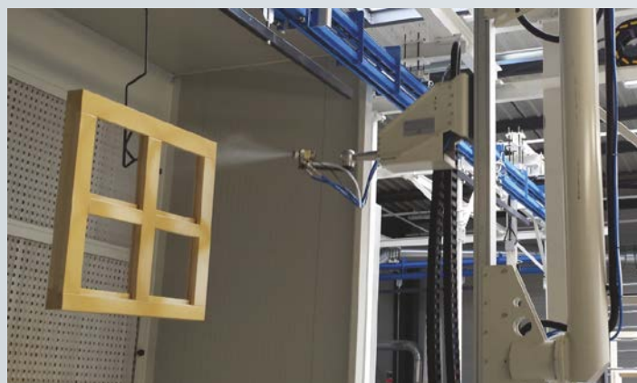
Robotul cartezian LeBot C5 poate gestiona cu ușurință diferite tipuri de ferestre și rame cu ajutorul barierei de scanare rapidă și a softului integrat.
