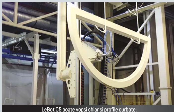
Robotul cartezian LeBot C5 poate gestiona cu ușurință diferite tipuri de ferestre și rame cu ajutorul barierei de scanare rapidă și a softului integrat.
