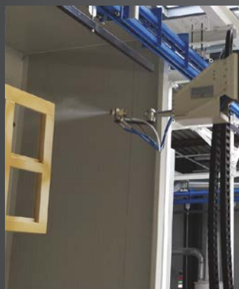
Robotul cartezian LeBot C5 poate gestiona cu ușurință diferite tipuri de ferestre și rame cu ajutorul barierei de scanare rapidă și a softului integrat.
